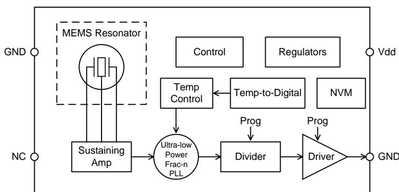
**Figure 2. MO1566 Block Diagram**
