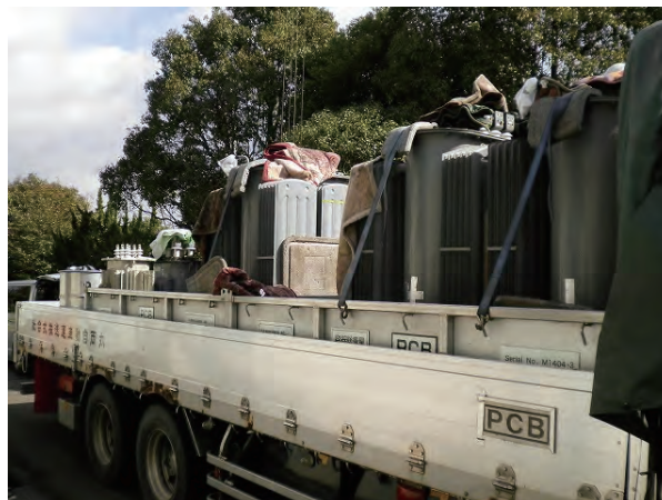
PCB 低濃度廃棄物を処理業者の専用車両へ引き渡す様子
