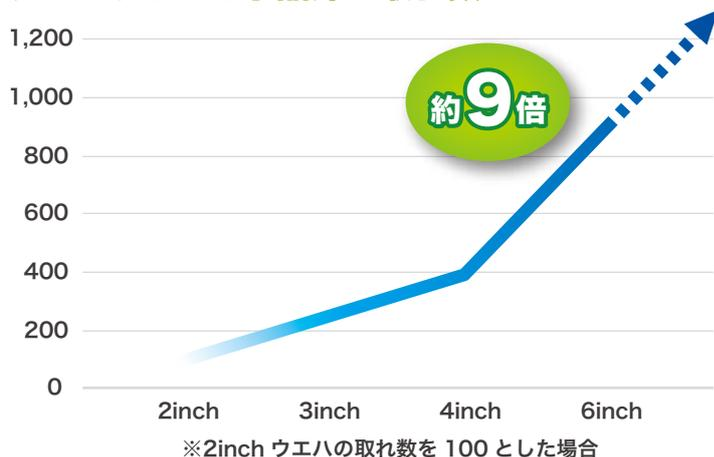
例えば 6inch サイズのウエハにおける水晶片の取れ数は 2inch サイズのウエハと比較すると約 9 倍にもなります。
